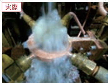
実際の高周波焼入れ における冷却剤噴射状況
