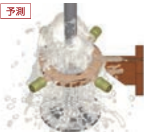
高周波焼入れ シミュレーションにおける 冷却剤噴射状況の予測
