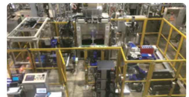
最新の三次元視覚センサーと産業用ロボットで全自動化を実現
