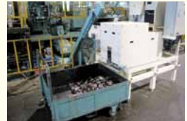
切粉の固形化処理のための圧縮機
