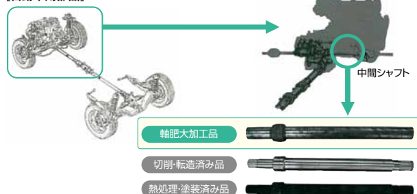
軸肥大加工した中間シャフトとその使用箇所
