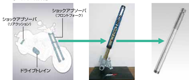
フロントフォーク用インナーチューブ使用箇所
