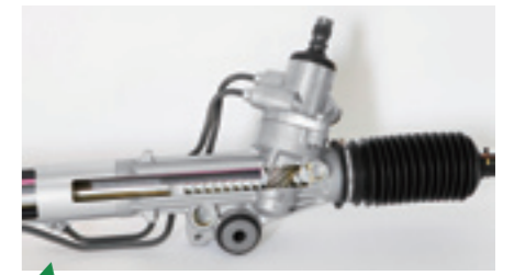
ステアリングギヤボックスの中にある中空ラックバー
