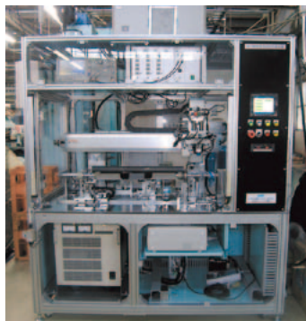
漏洩磁束探傷装置
