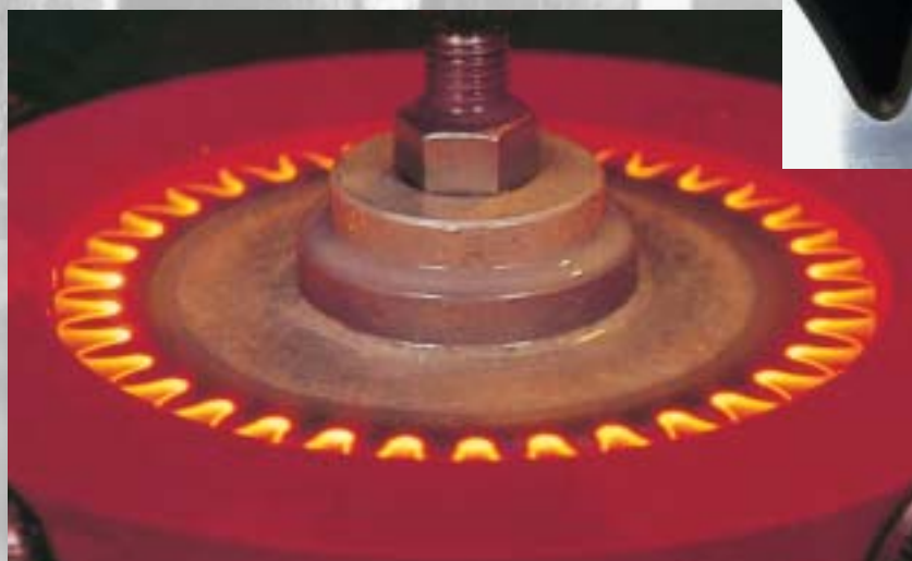
超急速短時間加熱による歯車輪郭焼入れ
