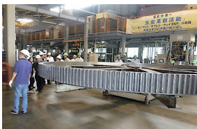
トンネルマシン用歯車付旋回ベアリング (外形 約8.0m)
