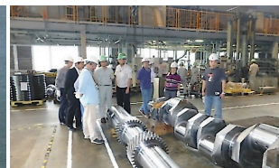
船舶エンジン用クランク軸 (全長 約3.9m) 産業機械用歯車付シャフト (全長 約2.2m)
