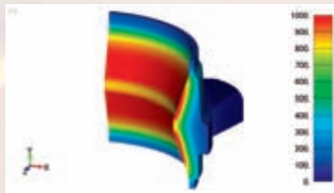
焼入時の部品断面の温度分布
