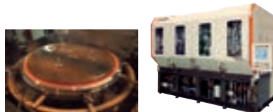
旋回輪の高周波焼入れ コンパクトC V J 焼入れ機
