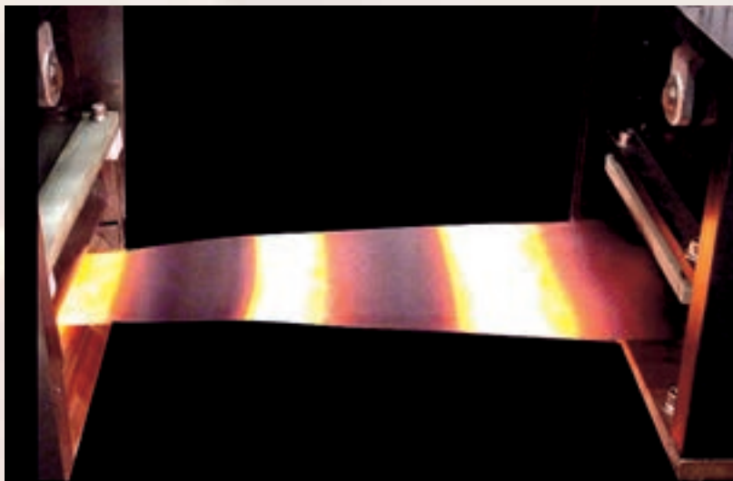
直接通電加熱（DH）による縞状部分硬化
