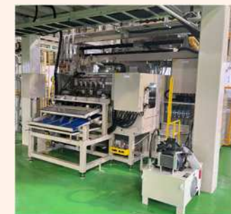
ドライブシャフト専用工場 韓国熱錬製4軸焼入装置
