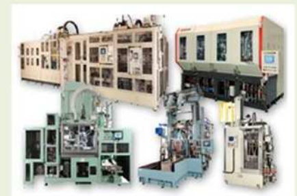
高周波焼入設備
