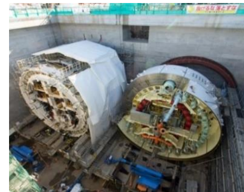
トンネルマシン用歯車付旋回ベアリング(外径8,000mm)
