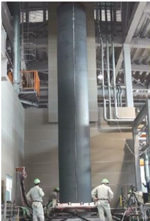
製紙機械用大型ヒートロール(中空) (直径1,350mm、全長9,000mm、重量50t)
