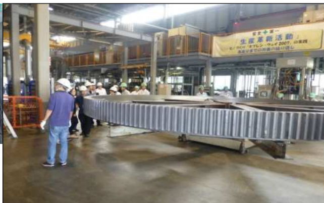
トンネルマシン用 歯車付回転ベアリング (外径8,000mm)
