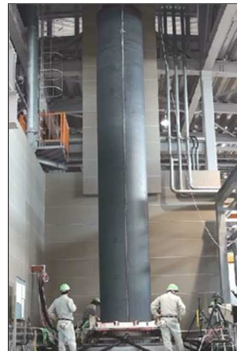
製紙機械用大型ヒートロール(中空) (直径1,350mm、全長9,000mm、重量50トン)
