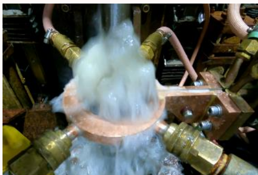
実際の高周波焼入れにおける冷却剤噴射状況
