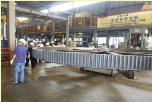
トンネルマシン用歯車付旋回ベアリング(外径8,000mm)
