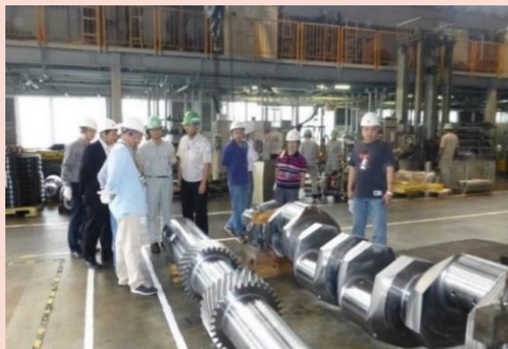
船舶エンジン用クランク軸(全長 約3,900mm) 産業機械用歯車付シャフト(全長 約2,200mm)
