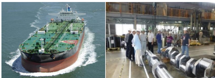
船舶エンジン用クランク軸(全長 約3.9m) 産業機械用歯車付シャフト(全長 約2.2m)
