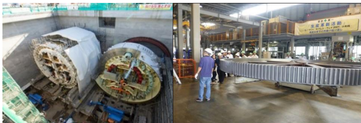
トンネルマシン用歯車付旋回ベアリング (外径 約8.0m)
